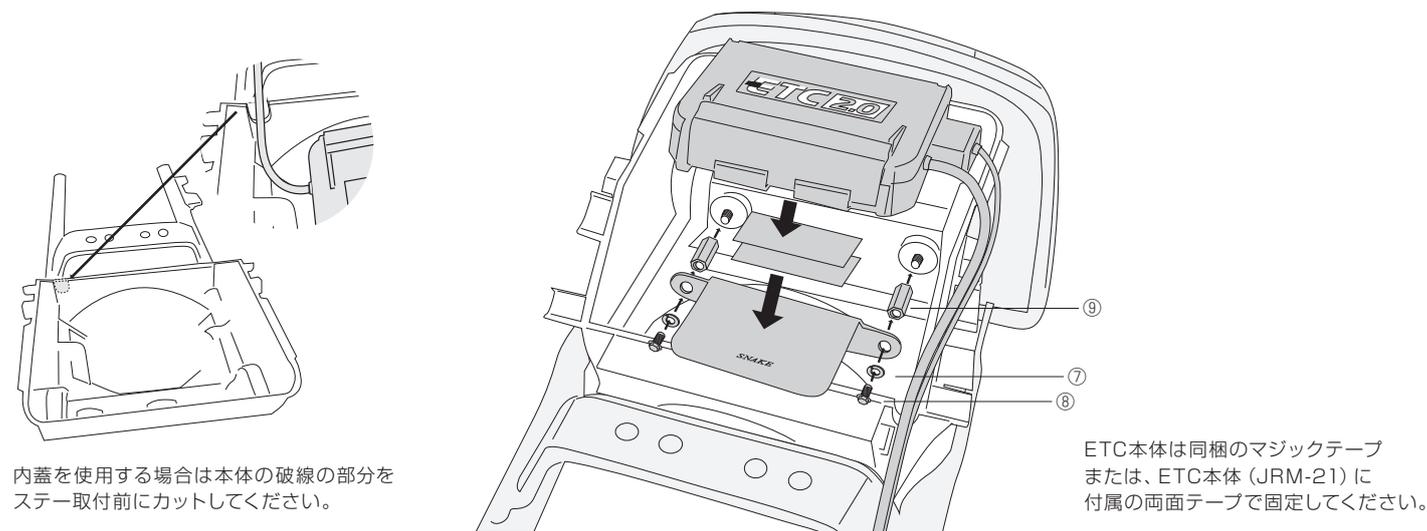
内蓋を使用する場合は本体の破線の部分をステータ取付前にカットしてください。
